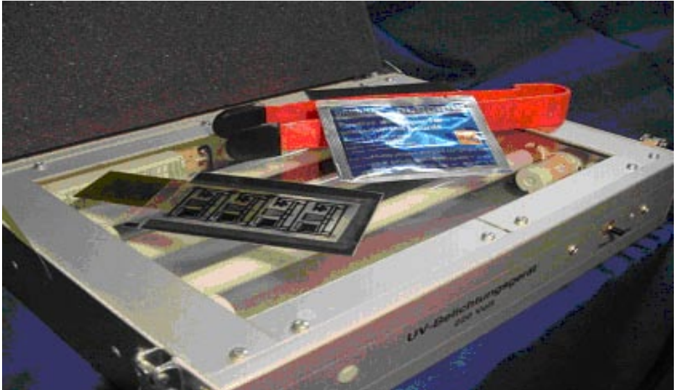
Belichtungsgerät, Entwickler und Vorlagetasche mit belichtetem Blech
